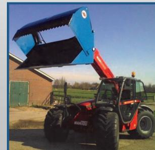
Alle Typen sind verfügbar mit Zinken oder einem dichten Boden. Einzigartig bei dem dichten Boden ist, dass dieser doppelwandig ist und damit völlig glatt. Es bleiben keine Futterreste am Boden zurück. Daneben kann der Boden einfach in der Silage gesteckt werden.
